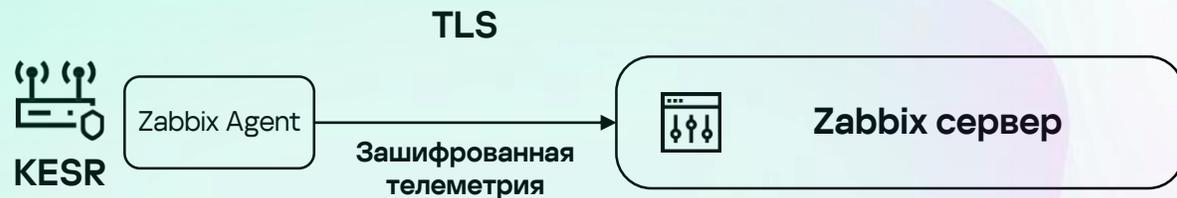
Добавление поддержки TLS в Zabbix агентах на KESR позволяет пересылать трафик телеметрии на Zabbix сервер в зашифрованном виде, в том числе вне туннелей.
