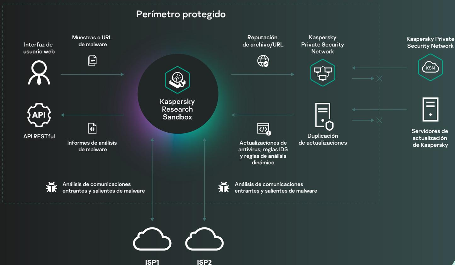
El producto es compatible con la implementación en hardware. La configuración del hardware depende del rendimiento requerido y se puede escalar. Requiere una conexión de red de 100 Mbps para cada canal y al menos una conexión de proveedor de servicios de Internet (ISP) independiente (se recomiendan dos o más para la tolerancia a errores). El ISP debe estar atento y listo para detectar tráfico malicioso.
