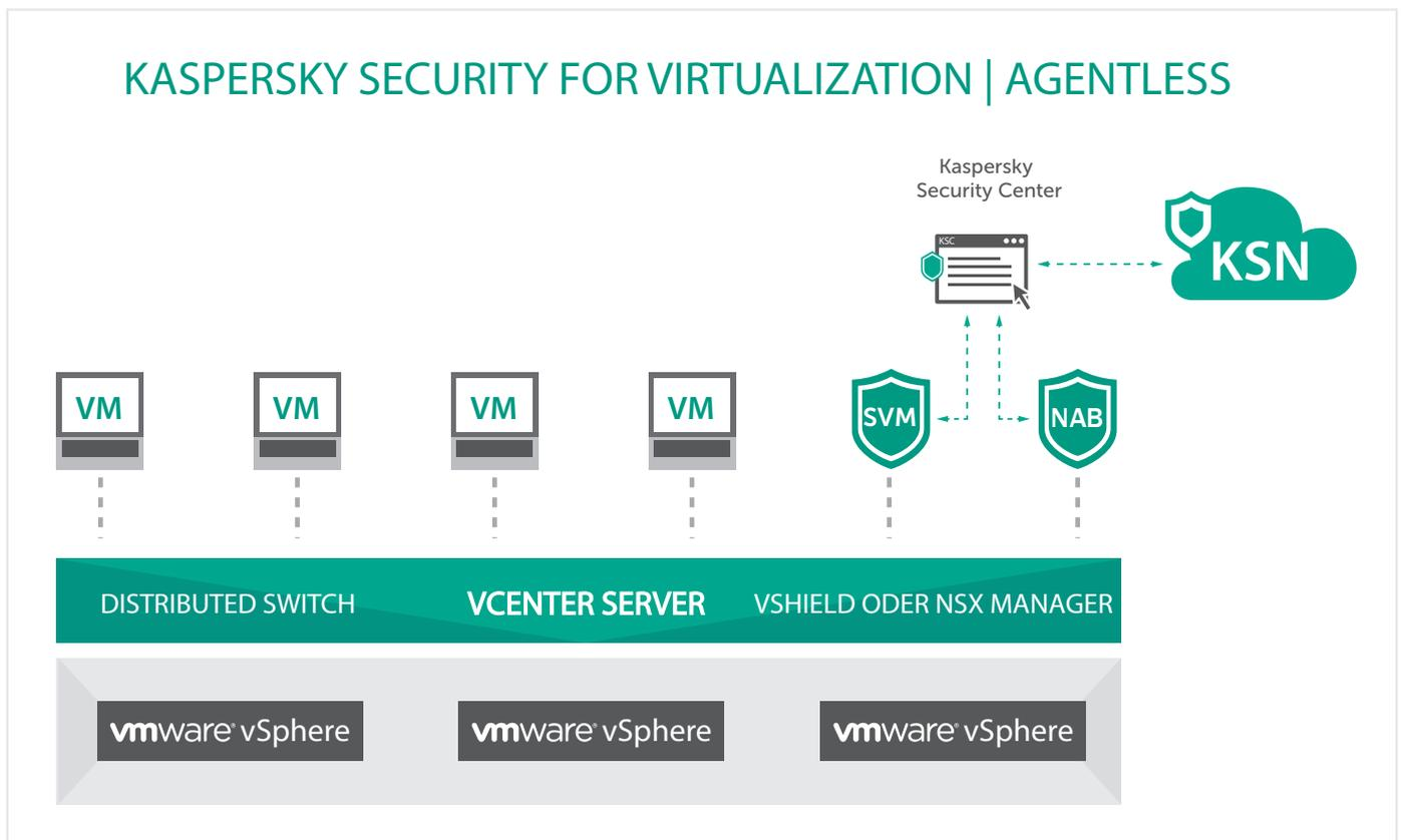
Zur Steigerung des Netzwerkschutzes kann eine zweite SVM eingesetzt werden, um die Funktionalität von Kaspersky Network Attack Blocker mit enger Integration in die VMware NSX-Plattform sowie in die Komponente vCloud Networking & Security bereitzustellen.
